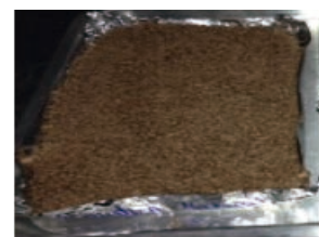
Figura 3. Almidón sin modificar mezclado con PP al 20% en peso.
