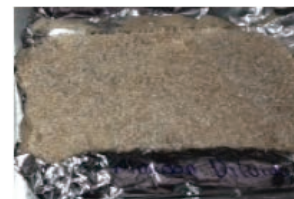
Figura 4. Almidón modificado mezclado con PP al 20% en peso.
