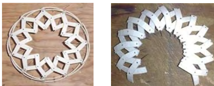
FIGURAS 160, 161. La geometría de los módulos de tijeras puede llegar a componer estructuras geodésicas plegables. Fuente: Fotos Experimentales, Morales, C. C. (2009).
