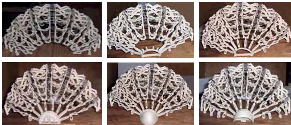
FIGURAS 124 A LA 129. La colocación del domo recto ayuda a estabilizar el empuje de los arcos a un arco montable central, en donde aterriza las tensiones. Fuente: Fotos Experimentales, Morales, C. C. (2009).
