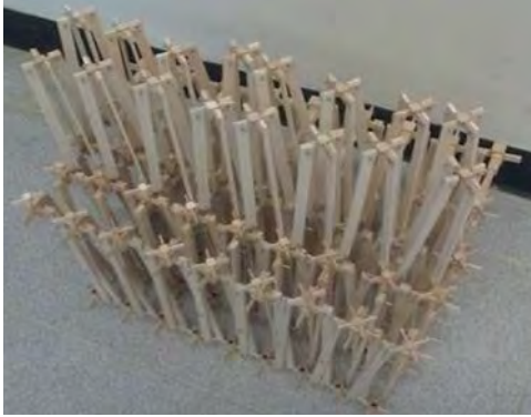
FIGURAS 192, 193. El armado de los arrostros fue una de las conexiones clave para las cubiertas desplegables, ya que es la que estabiliza a cada módulo conectado entre sí. Fuente: Fotos Experimentales, Morales, C. C. (2010).
