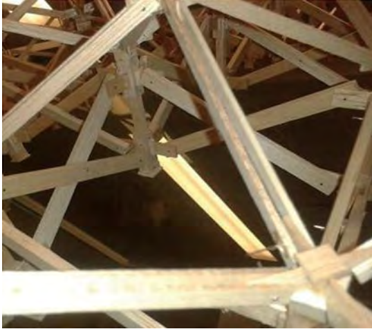
FIGURAS 230, 231. El modelo escalado a 1:20 ayudó a la elaboración del nudo constructivo, de igual manera la utilización de software especializado también ayudó a modelar con más eficiencia las conexiones que podría tener el sistema plegado de la cubierta. Fuente: Fotos Experimentales, Morales, C. C. (2014a).
