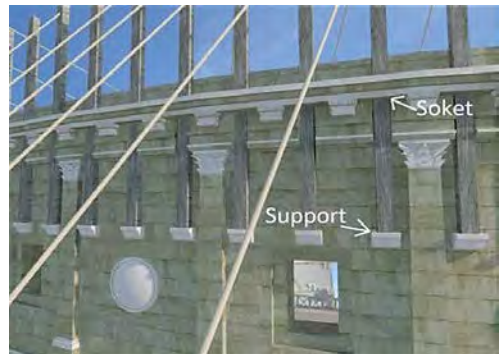
FIGURA 10. Los 250 mástiles eran colocados en la parte superior del Coliseo a más de 48 metros de altura. Imagen extraída y redigitalizada de the-colosseum.net, Morales, C. C. (2018).
