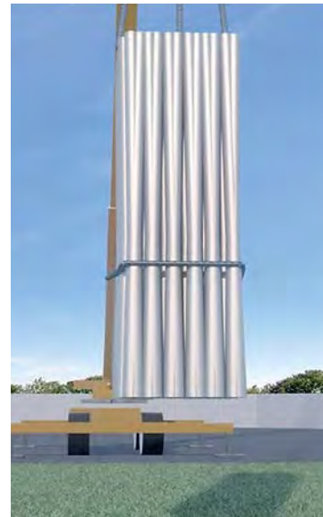
FIGURAS 292, 293. Esquema de carga de la cubierta plegable al camión. Es importante comentar que la facilidad de transporte del sistema ayuda a mejorar la velocidad de construcción de la cubierta en el sitio. Imagen extraída y redigitalizada. Fuente: Escrig, F. (1997), Morales, C. C. (2018).
