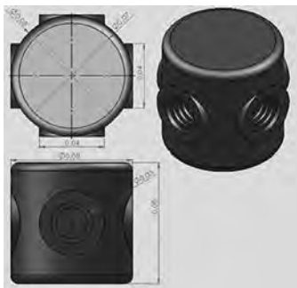
FIGURA 306. Esquema y medidas del modelo tentativo para manufacturar el nodo de contraventeo de la cubierta. Fuente: Morales, C. C. (2015a).
