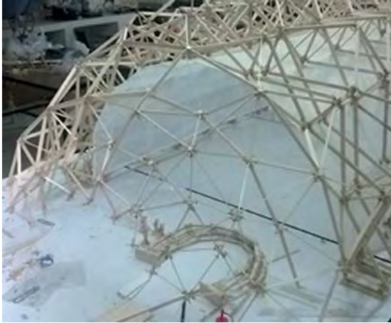
FIGURA 198. La última etapa del modelo sirvió para comprobar la interacción de la geometría plegable de la geodésica con la cubierta, por lo cual nos deja conceptos de diseño para desarrollar la geometría plegable del modelo final. Fuente: Fotos Experimentales, Morales, C. C. (2014a).
