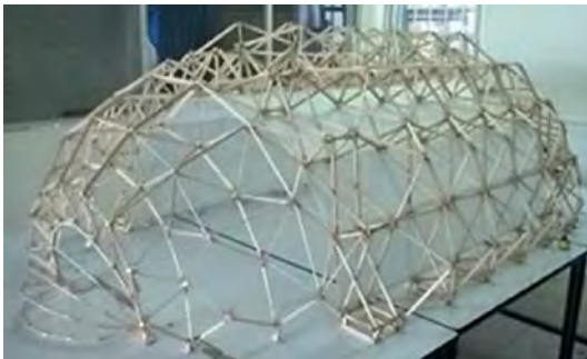
FIGURAS 199, 200. La geodésica se tuvo que rigidizar por medio de arcos y una sobreestructura ya que no tenía la estabilidad adecuada, también se remató con arco en el borde que ayudó a formar la figura final del modelo. Fuente: Fotos Experimentales, Morales, C. C. (2014a).
