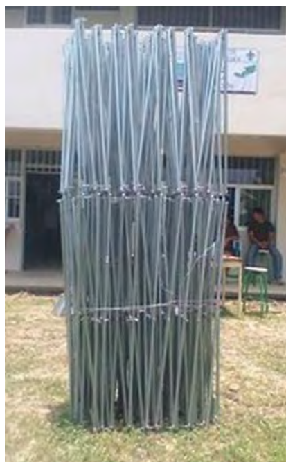
FIGURAS 299, 300. Una vez construido el paquete de aspas, se realizará el despliegado de la estructura en el sitio para comprobar sus despliegado y plegado de la cubierta transformable. Fuente: Morales, C. C. (2015a).
