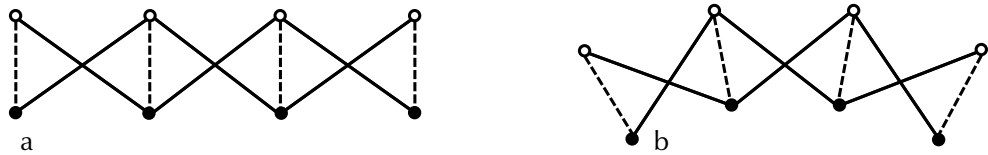
FIGURA 96. Principios conceptuales de desarrollo de estructura de tijeretas y sus condiciones de plegado, Fuente: Escrig, F. (2012).
