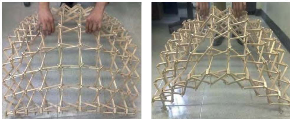
FIGURAS 181, 182. La cubierta integrada con sus dos partes funciona establemente. Fuente: Fotos Experimentales, Morales, C. C. (2010).
