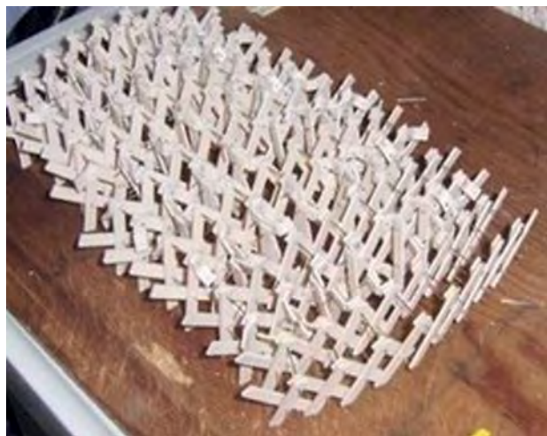
FIGURA 113. La estructura transformable en este caso tiene la propiedad de ser generada con arcos plegables que abren en ambos sentidos para hacerlo aún más prácticos. Fuente: Fotos Experimentales, Morales, C. C. (2009).
