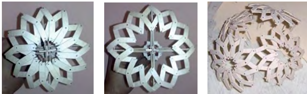
FIGURAS 140 A LA 142. La generación de la forma de las tijeras puede utilizarse para generar todo tipo de formas plegables. Fuente: Fotos Experimentales, Morales, C. C. (2009).
