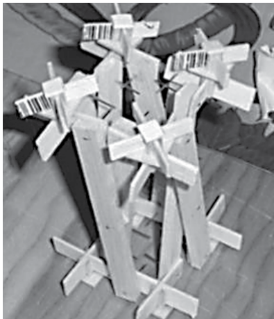
FIGURAS 176, 177. La experimentación nos ayuda a generar los parámetros de diseño, para construir el modelo correcto de la geometría plegable y este nos ayuda a verificar los errores. Fuente: Fotos Experimentales, Morales, C. C., 2010.
