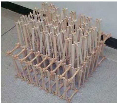
FIGURAS 194, 195. Posteriormente, en el armado final de la cubierta, se analizó que todas las partes fuesen compatibles y no tuviera ningún error de conexión. Fuente: Fotos Experimentales, Morales, C. C. (2010).
