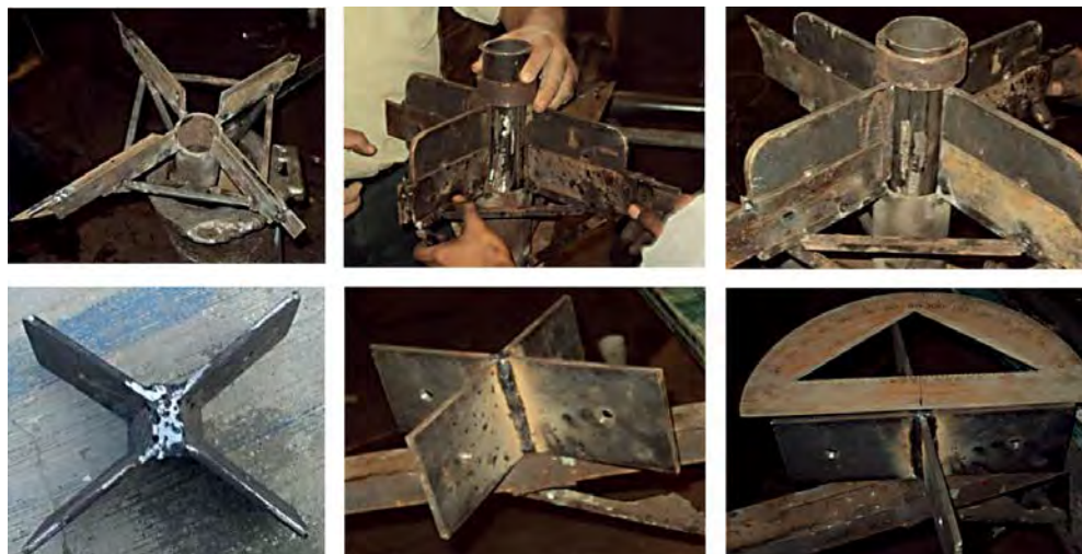
FIGURA 255 A LA 260. Evidencia fotográfica del manufacturado del prototipo: se desarrolló una base de armado industrial para construir el nodo de la forma más sencilla posible y que no costara demasiado en esta etapa de pruebas constructivas. Fuente: Morales, C. C. (2012a).
