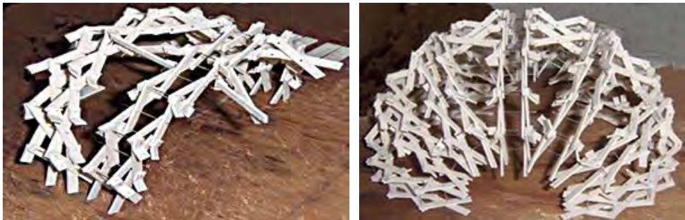
FIGURAS 122, 123. La figura del armazón puede tener varias formas, esto pasa por la colocación de los rigidizadores que se encuentran en la punta de los arcos, en donde se colocan para definir la geometría de la estructura. Fuente: Fotos Experimentales, Morales, C. C. (2009).
