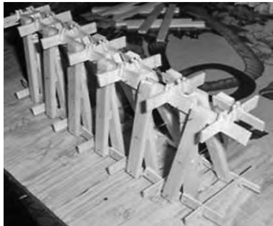
FIGURAS 178, 179. El marco de alma abierta se elaboró con combinaciones de ángulos y nodos, este sería una conexión importante para el proyecto de investigación, ya que resuelve la estabilidad de la geometría. Fuente: Fotos Experimentales, Morales, C. C. (2010).
