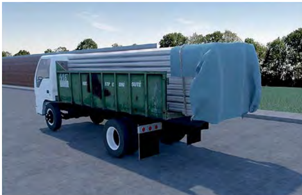
FIGURAS 292, 293. Esquema de carga de la cubierta plegable al camión. Es importante comentar que la facilidad de transporte del sistema ayuda a mejorar la velocidad de construcción de la cubierta en el sitio. Imagen extraída y redigitalizada. Fuente: Escrig, F. (1997), Morales, C. C. (2018).
