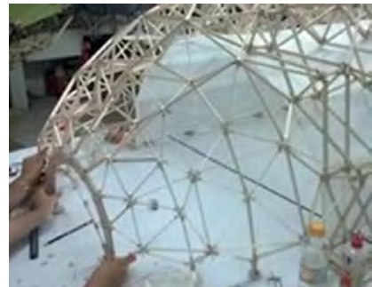
FIGURAS 199, 200. La geodésica se tuvo que rigidizar por medio de arcos y una sobreestructura ya que no tenía la estabilidad adecuada, también se remató con arco en el borde que ayudó a formar la figura final del modelo. Fuente: Fotos Experimentales, Morales, C. C. (2014a).
