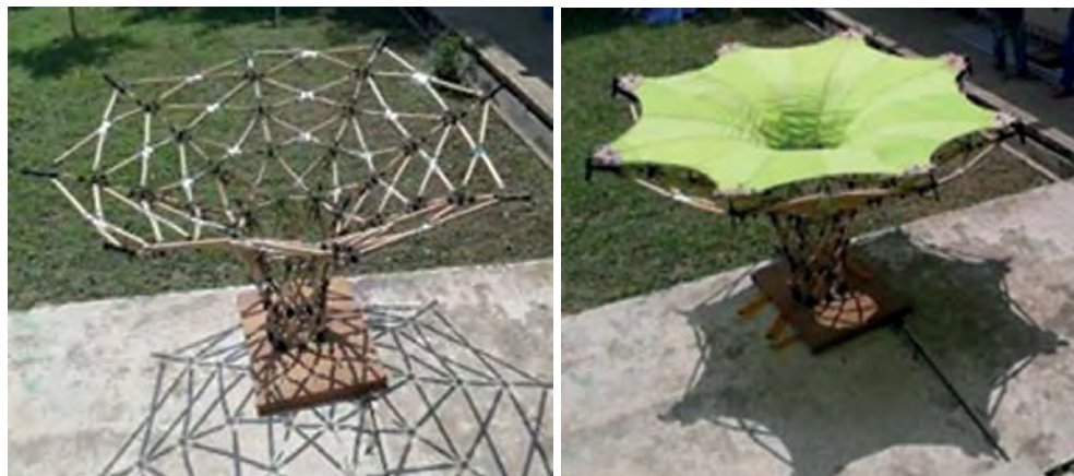
FIGURAS 310, 311. Modelos prototipados para desarrollar geometrías complejas en los sistemas plegables desarrollados en el Laboratorio de Estructuras. Fuente: Morales, C. C. (2014a).
