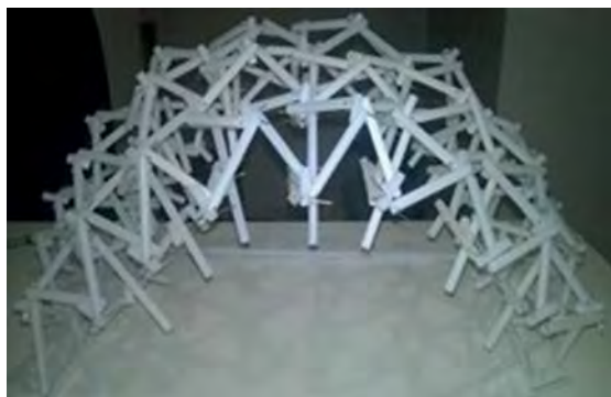
FIGURA 242. La unificación de la cubierta plegable se adecua gracias a que se simplifica la forma geométrica de las aspas, dando como resultado una figura óptima y eficiente. Fuente: Morales, C. C. (2015a).
