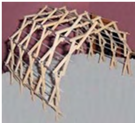
FIGURAS 72, 73. La retícula celular es un buen principio de diseño modular y de cómo se adapta el espacio a un terreno irregular. Esto dio paso a fabricar una malla plegable hacia ambos sentidos. Fuente: Fotos Experimentales, Morales, C. C. (2009).
