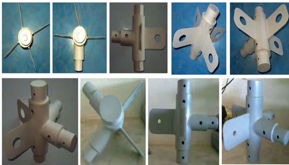
FIGURA 254. Evidencia fotográfica del prototipo: desarrollo del modelo experimental en sus primeras fases de diseño, posteriormente se elaboró en acero. Fuente: Morales, C. C. (2012a, 2014c).
