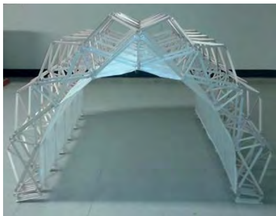
FIGURAS 196, 197. La cubierta ya terminada tendrá el pretensado correcto para rigidizar la cubierta cilíndrica retráctil. Fuente: Fotos Experimentales, Morales, C. C. (2010).
