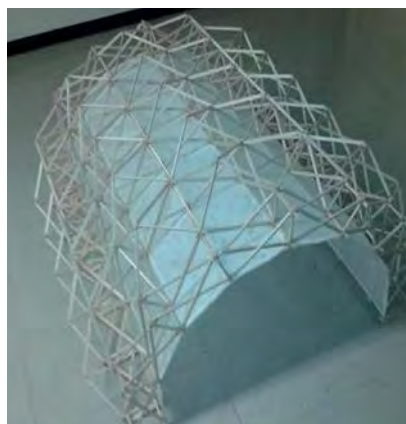
FIGURAS 196, 197. La cubierta ya terminada tendrá el pretensado correcto para rigidizar la cubierta cilíndrica retráctil. Fuente: Fotos Experimentales, Morales, C. C. (2010).
